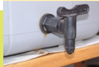
Dit kraantje werd niet lekdicht gemonteerd. Eens de bak in gebruik is het zo goed als onmogelijk om hieraan nog te verhelpen. Een gewaarschuwd wormenbakgebruiker...
