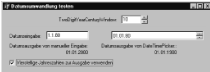
Abbildung 2.2: Ein Testprogramm für die Datumsumwandlung zeigt, dass die TDateTimePicker -Komponente bei zweistelliger Jahreseingabe das TwoDigitYearCenturyWindow nicht beachtet.
