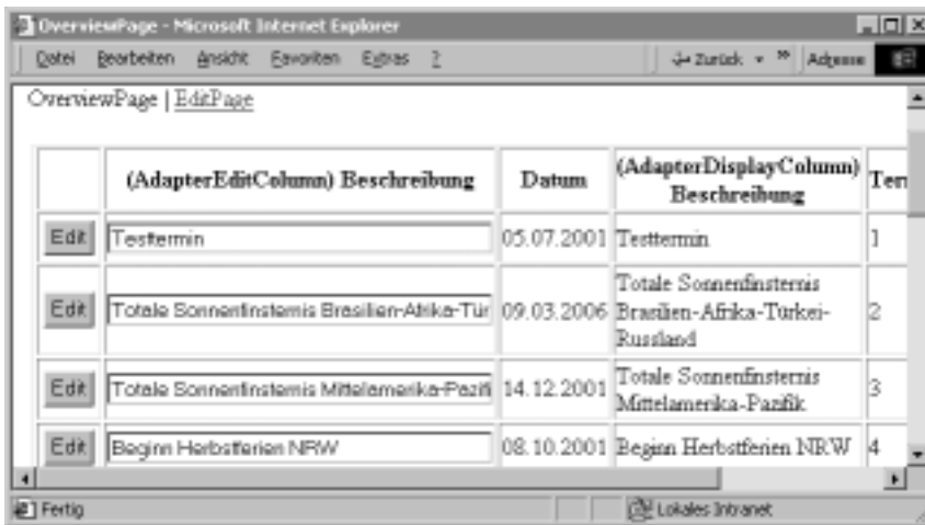
Abbildung 8.33: Die Termintabelle im Editiermodus. Da nur eine AdapterEditColumn -Komponente verwendet wurde, lässt sich auch nur eine Spalte editieren.
