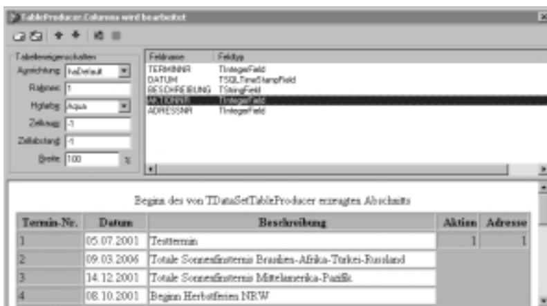
Abbildung 8.26: Zur Entwurfszeit wird ein TDataSetTableProducer in einem speziellen Editor mit Vorschaufunktion editiert.
