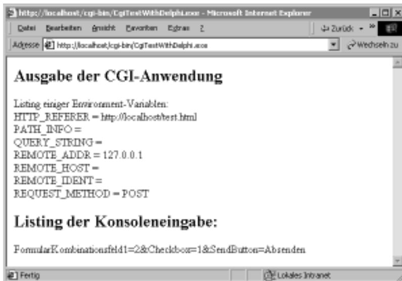
Abbildung 8.20: Ausgabe des Beispielprogramms mit Parametern bei Verwendung der Post-Methode
