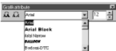
Abbildung 6.5: Eine TFontComboBox -Komponente mit DropDownCount = 5 zur Laufzeit
