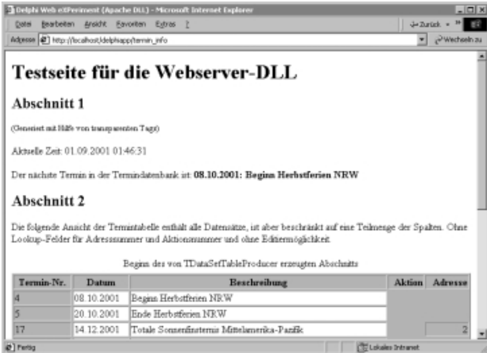
Abbildung 8.25: Die Datenbankseite wird durch einen PageProducer unter Zuhilfenahme eines DataSetTableProducers erzeugt.
