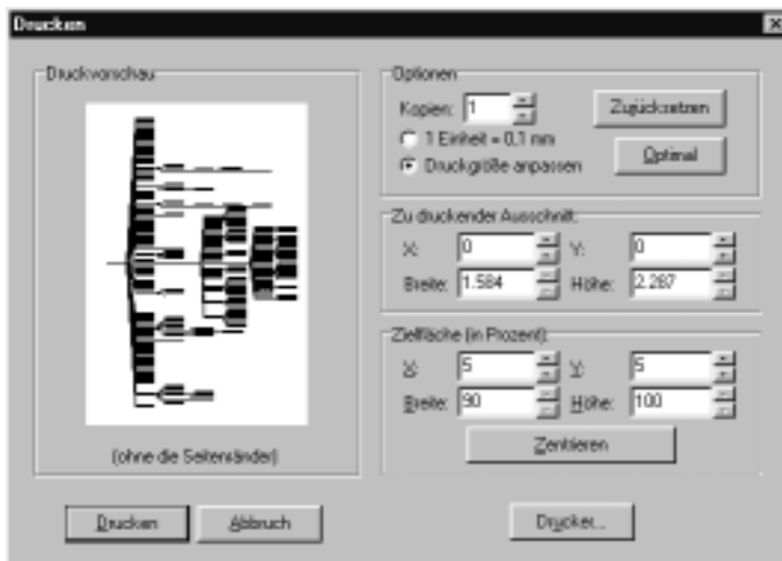
Abbildung 5.9: Nach Drücken des Schalters »Optimal«, Verkleinern der Zielfläche auf 90% und Verschieben der Zielfläche um jeweils 5% in X- und Y-Richtung wird diese Grafik zentriert gedruckt und füllt die Seite fast ganz aus.
