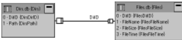
Abbildung 7.18: Die symbolische Darstellung der Haupt-/Detailverbindung des Beispielprogramms in der Diagramm-Ansicht
