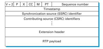
Figure 9.11 RTP header format.
